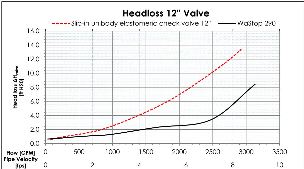
Fig. 4 HEAD LOSS COMPARISON BETWEEN A COMPETING INLINE CHECKVALVE AND THE WASTOP (US-UNITS)
